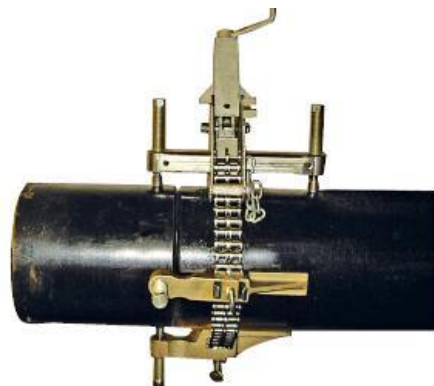
Соединение двух труб
